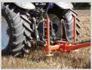
**+** CONCEPT "X" RAZOL disques décalés AV et AR et montage dégressif des disques AR pour un recroisement parfait et pour éviter tout risque de billonnage.
