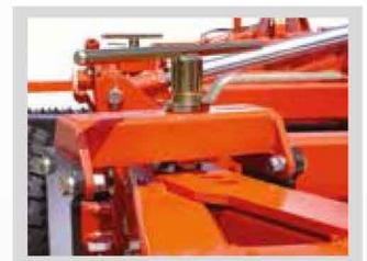
**+** PIVOTEMENT SUR ROULEMENT pour un réglage sans effort et plaque de maintien pour une meilleure rigidité à grande vitesse.
