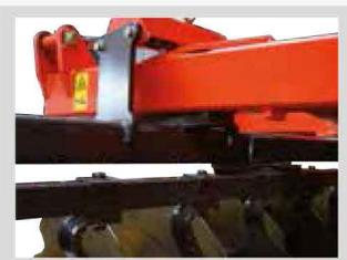
**+** RÉGLAGE DU ROULEAU ARRIÈRE manuel par 2 bras de poussée pour un réglage très précis de la profondeur de déchaumage. La lumière à l'extrémité des bras permet un réglage sans effort des rouleaux.
